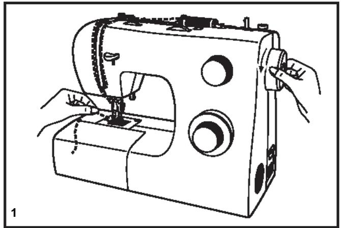
Tirer doucement vers le haut sur le fil supérieur de la bobine pour faire passer le fil de la canette à travers l'orifice de la plaque à aiguille (2). Reposer les deux fils à l'arrière sous le pied presseur. (3)
